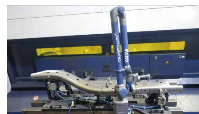
检测设备 FARO (法如) 七轴关节式测量臂
