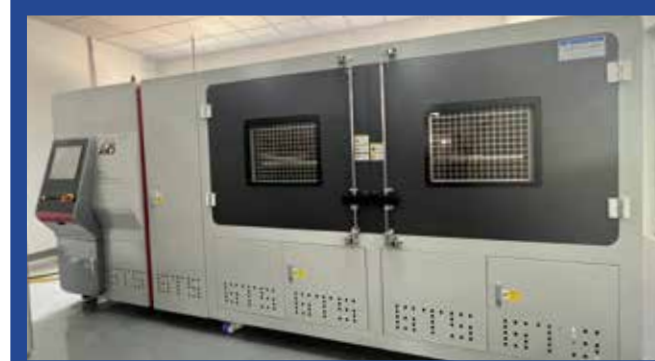
内腐蚀试验台
