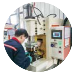
扩散焊接 Diffusion Welding
